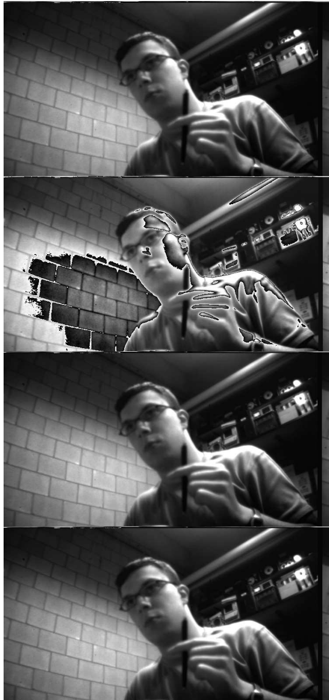
Figuur 3.8: Dit is de data die in de geheugenbuffer aanwezig was nadat de programma-uitvoering op een willekeurig moment werd gestopt. De afbeelding werd met de image viewer van Visual DSP++ 4.5 gemaakt. De circulaire buffer, die tijdelijk in het externe geheugen zit opgeslagen, is duidelijk zichtbaar als 4 opeenvolgende videoframes onder elkaar. De tweede afbeelding in de buffer van bovenaan te beginnen, werd laatst gemaakt. Dat is zichtbaar doordat de grijstinten nog niet naar 8-bits per pixel werden gecorrigeerd.
